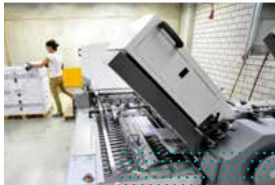
Schallschutz an einer Falzmaschine
