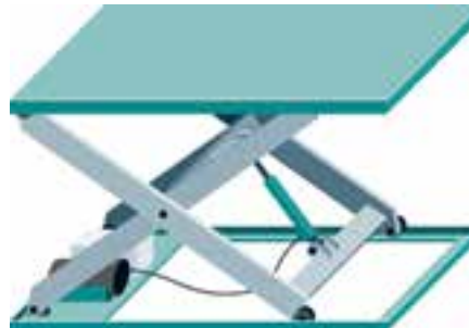
Scherenhubwagen: Bewegliche Hebegeräte mit hydraulischem Hubwerk, das von Hand oder von einem Elektromotor gesteuert wird; das Fahrwerk ist nicht kraftbetrieben.
