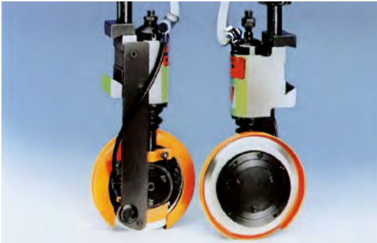
Sicherung eines Rotationsmessers: Der Schutz muss das Messer bis auf die Schneidstelle verdecken.
