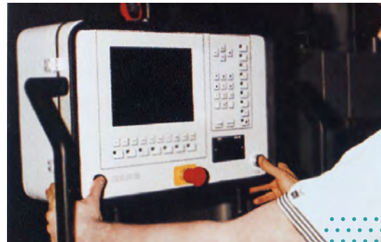
Zweihandschaltung: Der Abstand zwischen beiden Stellteilen muss mindestens 260 mm betragen.
