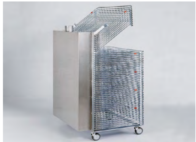
Fest montierte Absaughaube für Stapeltrockner im Siebdruck
