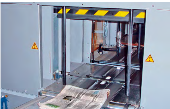
Sicherung der Quetschstelle zwischen Niederhalter und Zeitungspaket durch Kraftbegrenzung und Moosgummischicht auf der Unter- und Oberseite des Pressbalkens zum Schutz der Finger
