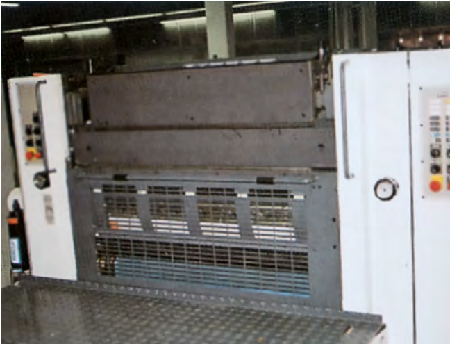
Beispiel für eine kombinierte Schutzeinrichtung an einer Bogenoffsetdruckmaschine
