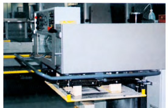
Sicherung durch abweisende Teile des Maschinengestells an der Auslage einer Bogenoffsetmaschine
