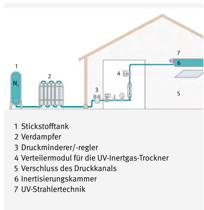
Einsatz des Inertgases Stickstoff in UV-Trocknungsanlagen
