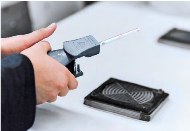
Einfache Messung der Ozonkonzentration mit einem Prüfröhrchen
