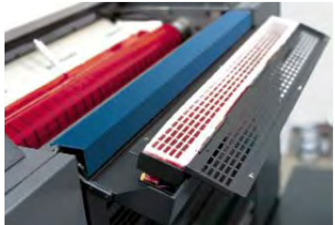
Farbnebelabsaugung am Druckwerk einer Bogenoffsetmaschine
