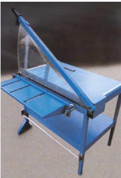
Fingerschutz an Handhebelschneidmaschine
