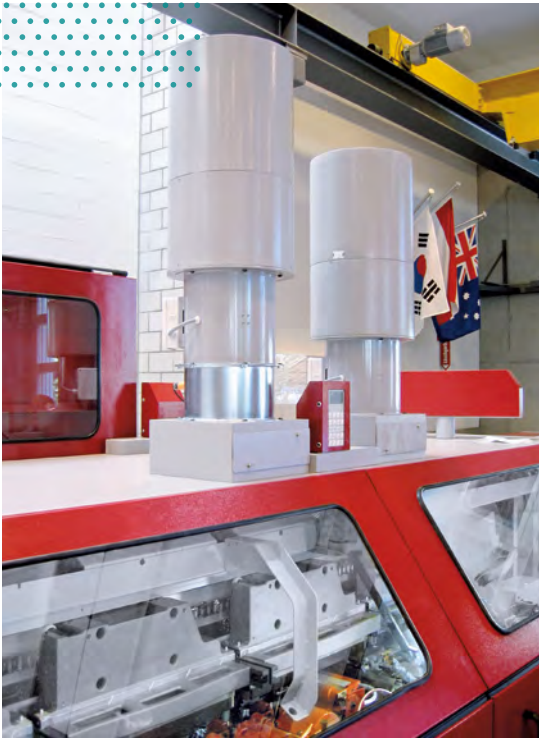
Absaugung am Klebebinder mit Aktivkohlefilter
