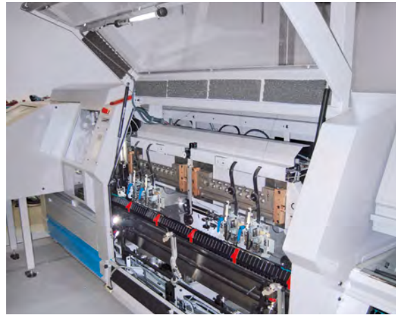
Großflächige, verriegelte, trennende Schutzeinrichtung in geöffneter Stellung
