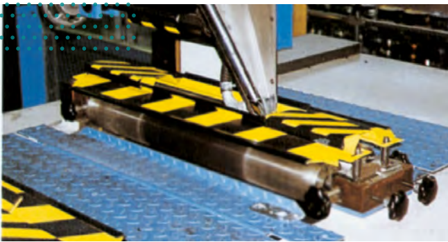
Beispiel für eine Sicherheitskennzeichnung am Trichterfalz einer Zeitungsoffsetdruckmaschine
