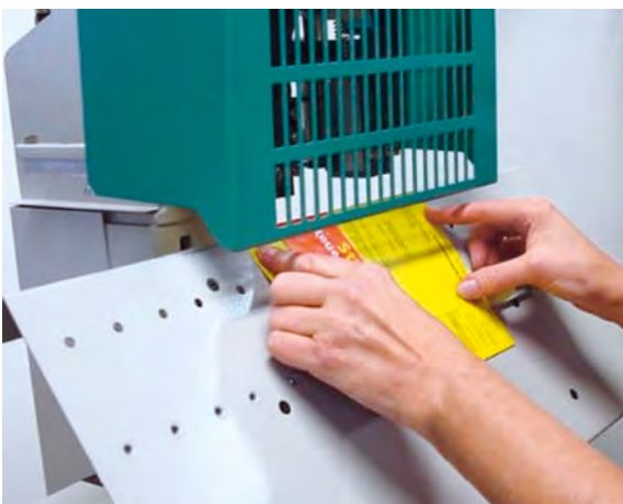
Sicherung der Gefahrstelle am Heftkopf einer Heftmaschine durch eine einstellbare trennende Schutzeinrichtung
