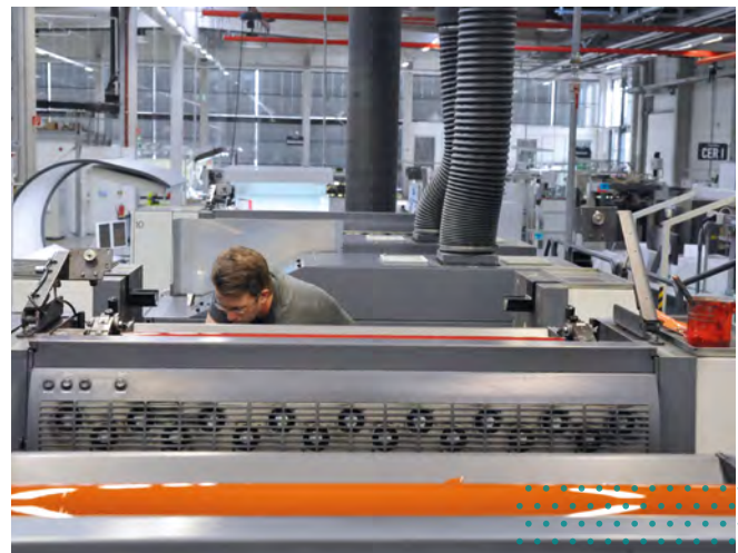
Trocknerabsaugung im Bogenoffsetdruck
