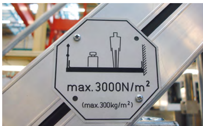
Belastungsangabe an einer Maschinentreppe
