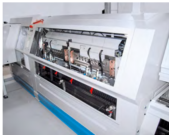
Großflächige, verriegelte, trennende Schutzeinrichtung in geschlossener Stellung
