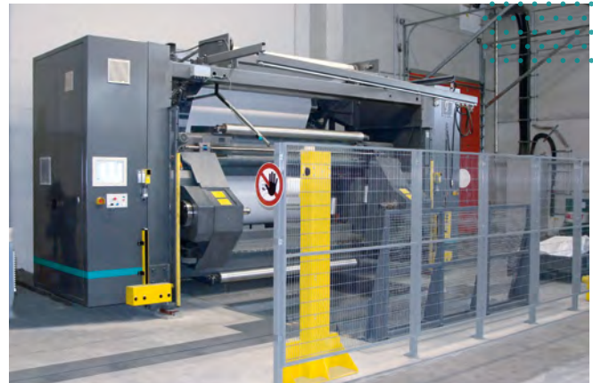
Sicherung des Gefahrenbereichs an einem Rollenwechsler einer Illustrationsoffsetdruckmaschine durch BWS
