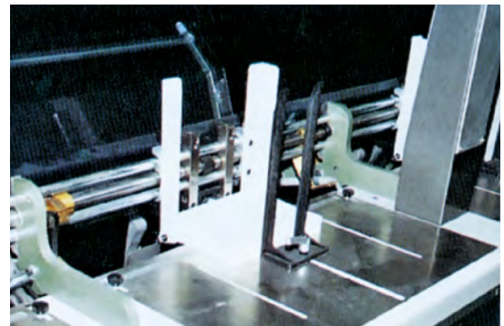
An Anlegern von Zusammentragmaschinen dürfen durch die Bewegungen der Vereinzlungselemente keine Verletzungsgefahren entstehen. Eine Sicherung ist z. B. durch Reststapelüberwachungen an den Anlegern möglich, an denen die Falzbögen von der Stapelunterseite der Maschine zugeführt werden.
