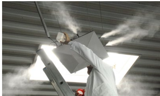
Wasserprobennahme zur Kontrolle der Keimbelastung des Befeuchterwassers
