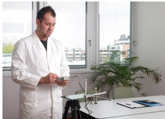
Messung der Lufttemperatur und der relativen Luftfeuchtigkeit
