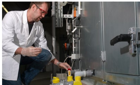
Keimzahlbestimmung mit Dip-Slides im Kondensat
