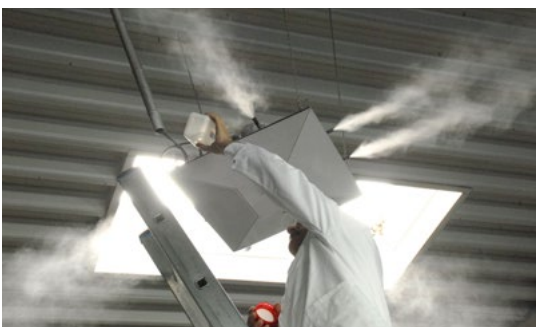
Wasserprobennahme zur Kontrolle der Keimbelastung des Befeuchterwassers
