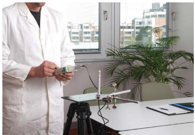
Messung der Lufttemperatur und der relativen Luftfeuchtigkeit
