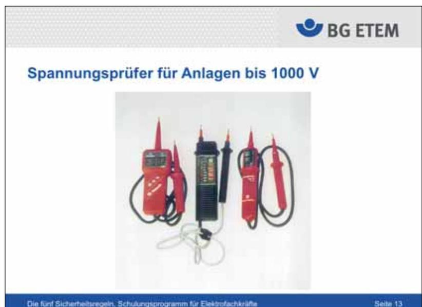
Slide 13: Spannungsprüfer für Anlagen bis 1000 V
