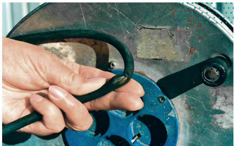
Defekte Leitung eines Leitungsrollers mit Metalltrommel; die Steckdosen erfüllen nicht die Schutzart IP 44.
