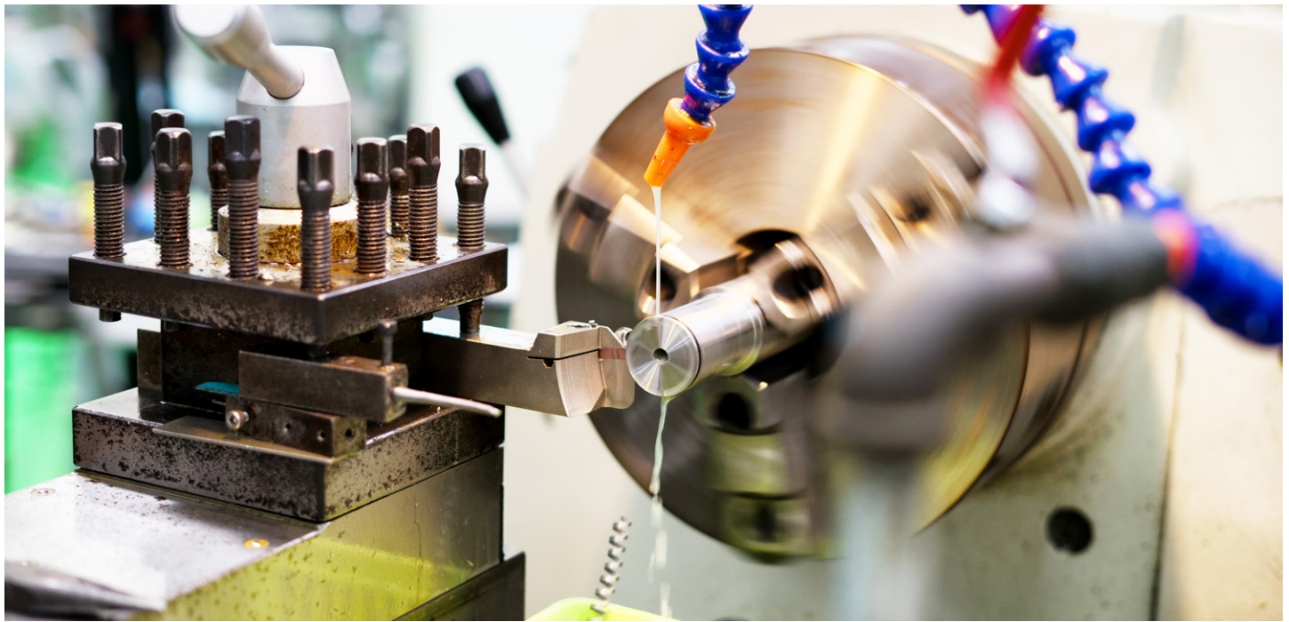
Abb. 2: KSS-Einsatz an einer Drehmaschine
