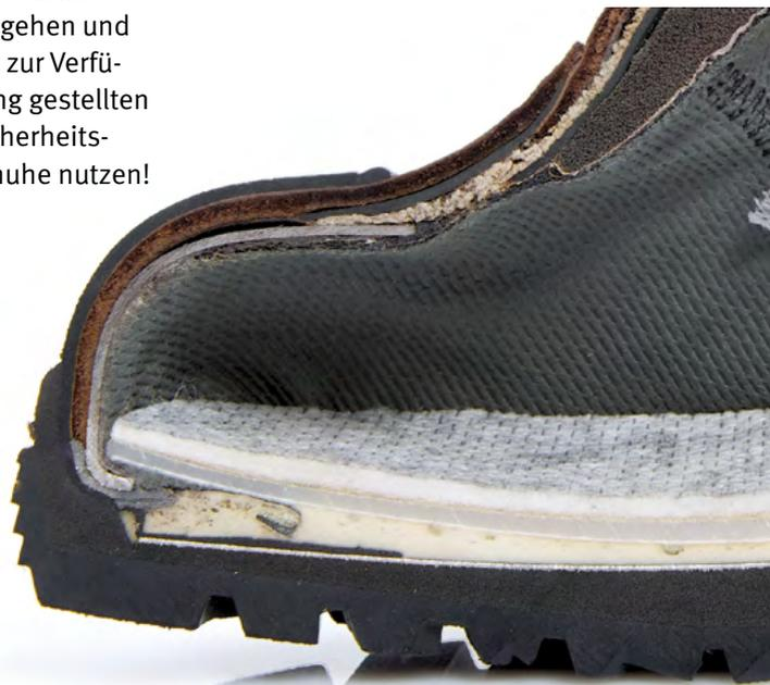
Längsschnitt durch einen Sicherheitsschuh: Der Schuh bietet Schutz gegen Anstoßen und Einklemmen des Vorderfußes durch die Zehenschutzkappe aus Stahl.
