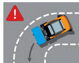
Kippen des Staplers bei Kurvenfahrten
