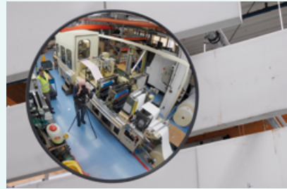
Mehr Sicherheit: Plan- und Halbrundspiegel entschärfen tote Winkel.
