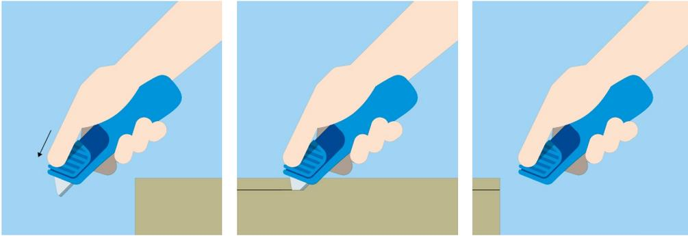
Die Klinge mit dem Schieber aus dem Gehäuse herausschieben, an Schneidgut ansetzen und schneiden. Die Klinge zieht sich beim Verlassen des Schneidguts vollautomatisch zurück, selbst wenn der Schieber noch gehalten wird.
