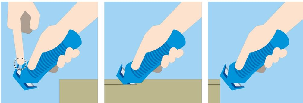
Messer in das Schneidmaterial einführen und schräg (45°) entlang der Schnittlinie schneiden.
