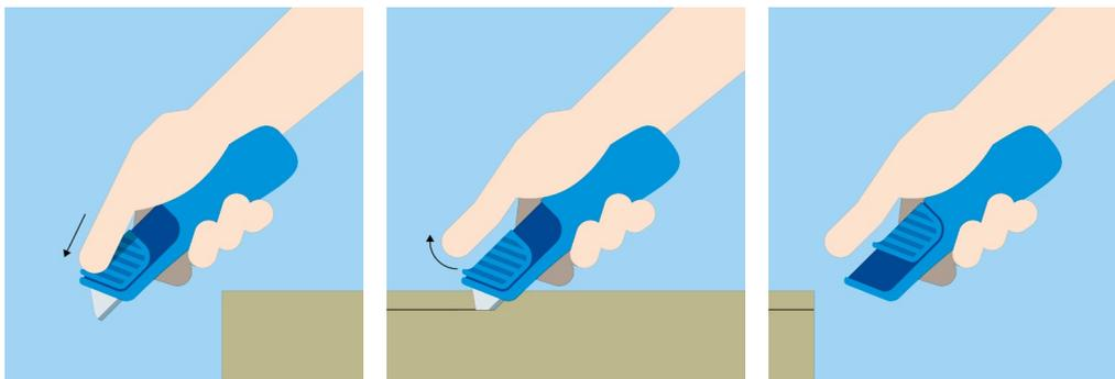
Die Klinge zieht sich beim Verlassen des Schneidguts nur zurück, wenn der Schieber losgelassen wurde! Durch Halten des Schiebers wird die Sicherheitsfunktion außer Kraft gesetzt.
