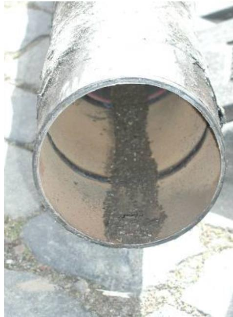
Rohrwand-Rauigkeit, Ablagerungen oder Rückstände führen zu Leckagen/Schleichgas
