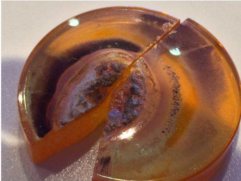
Die ZnSe-Linse kann sich bei CO<sub>2</sub>-Lasern, im Fehlerfall unter Umständen in ihre gefährlichen Bestandteile zersetzen!
