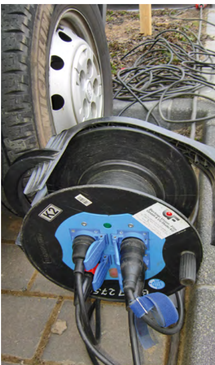
Geeigneter Leitungsroller mit Prüfplakette
