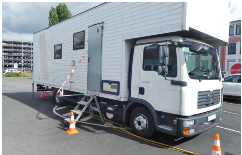
Ein einfacher Schutz, um Stürze zu verhindern, sind z. B. Handlauf und Markierung der Kabelstränge.
