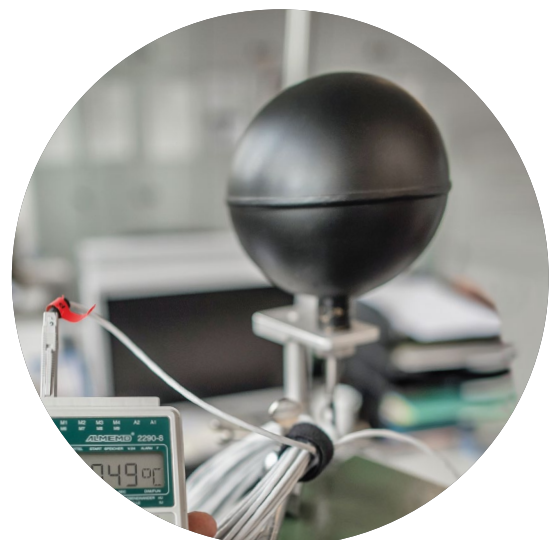
Messung der Globe-Temperatur mit einem Globe-Thermometer
