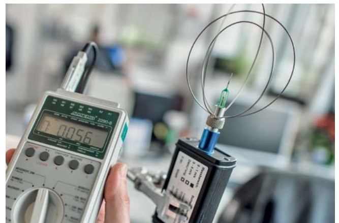
Messung der Luftgeschwindigkeit
