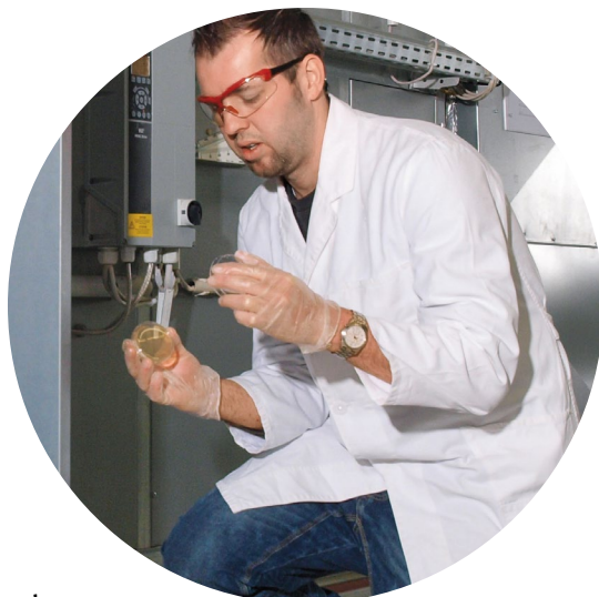
Abklatschprobe in einer Lüftungszentrale
