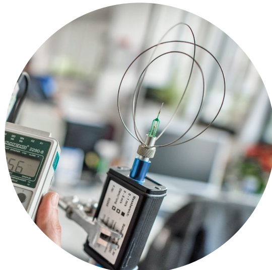
Messung der Luftgeschwindigkeit
