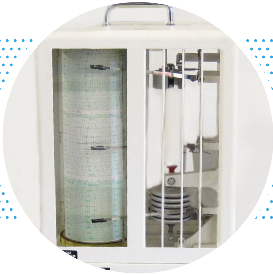
Thermohygrograph zur Messung von Lufttemperatur und relativer Luftfeuchtigkeit
