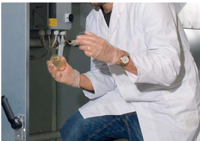
Abklatschprobe in einer Lüftungszentrale
