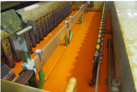
Abb. 4: Einsatz von Netzmitteln beim Verchromen
