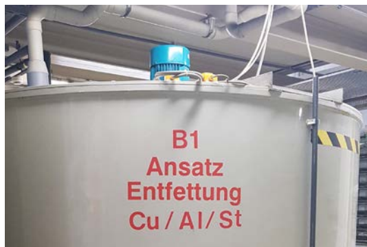
Abb. 6: Fertigansatz für die Versorgung von Prozessbehältern
