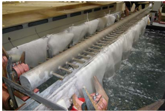
Abb. 5: Kathodenumhüllung zur Reduzierung der Schwefelsäure-Aerosole beim Eloxieren
