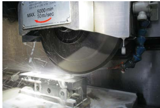
Abb. 11: Offene Erfassung bei Vor- und Nachbehandlungsprozessen (z. B. beim Schleifen)
