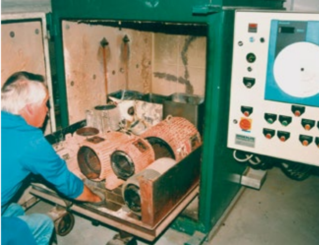
Abb. 5: Beladung eines Anwärmofens
