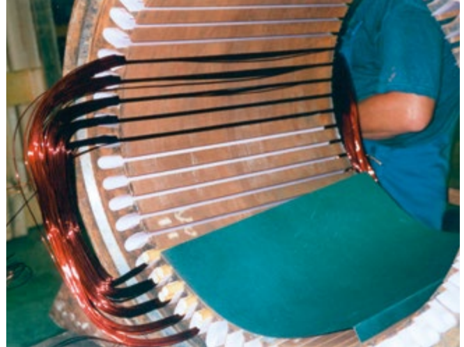
Abb. 6: Einbringen von Wickelpaketen in einen Stator
