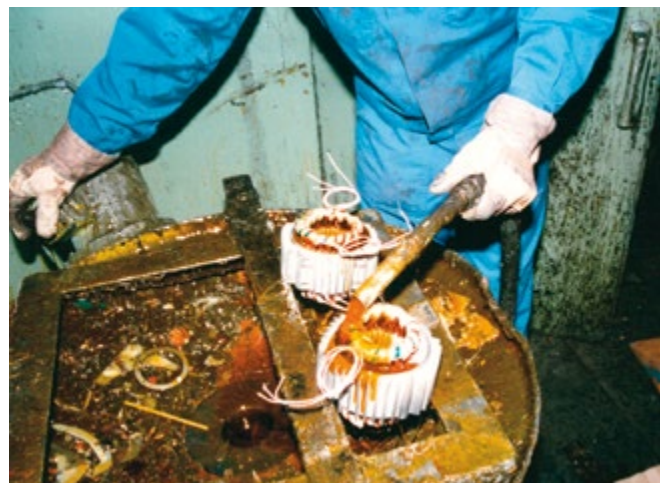
Abb. 8: Anwendung des Träufelverfahrens
