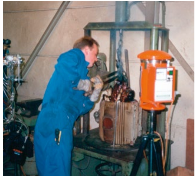
Abb. 10: Messungen beim Herausziehen der Wicklungen nach thermischer Vorbehandlung
