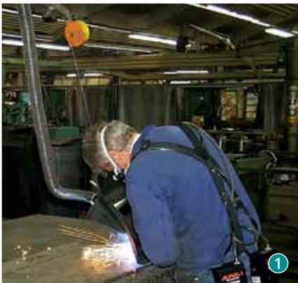
Erfassungseinrichtung prüfen, keine Knicke in der Schlauchverbindung (Rohrleitung), Zugentlastung leicht einstellbar.
