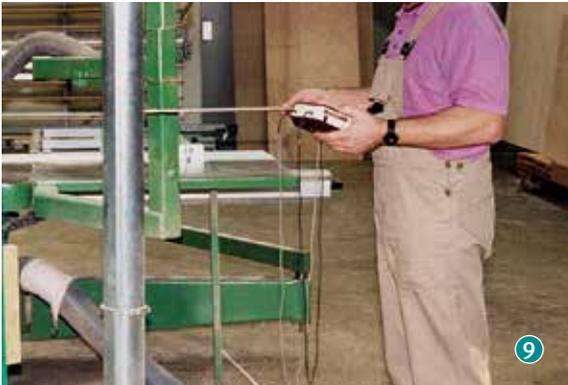
Messung der Strömungsgeschwindigkeit mit einem Flügelradanemometer in einer Rohrleitung
