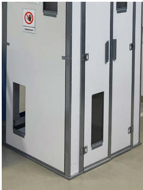
Abb. 6: Einkammer-Personenschleuse in faltbarer Ausführung
