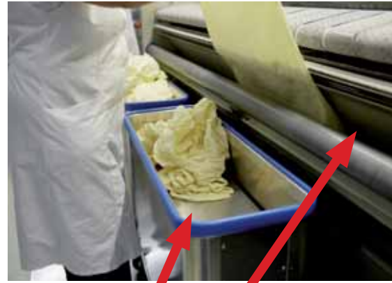
Abb. 15: Ergonomische Eingabe durch schmalen Wäschewagen mit Federboden, Saugschacht
