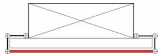
Abb. 9: Draufsicht Maschine für seitliche Eingabe, Arbeitsgang Groß- teilaufgabe, Trittblech offen, feste Sicherung seitlich und hinten
