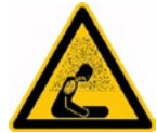
Beim Löschen mit CO 2 - Löschern in einem geschlos- senen Raum: Hinweise der DGUV Information 205-034 beachten!
