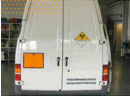
**7** Nach dem Beladen des Fahrzeuges mit einem Isotop muss der Wagen entsprechend gekennzeichnet werden.
