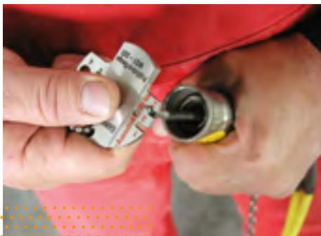
**17** Bei einem Teil der Arbeitsbehälter wird vom Hersteller eine Prüfschablone für Kugelkopf und Kugelpfanne mitgegeben. Nur wenn beide Teile unbeschädigt sind, können Strahlerhalter und Fernbedienung sicher miteinander verbunden werden.
