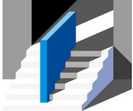
Schattenbildung hilft beim Erkennen heller Treppenstufen.
