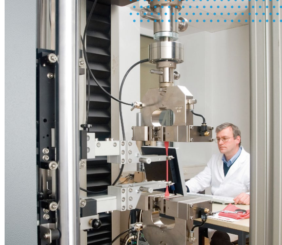
Zugprüfung an einem Probestück aus Elastomer
