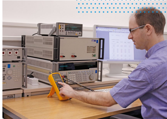
Kalibrierung eines Handmultimeters im Kalibrierlaboratorium
