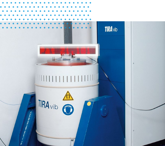
Schwingungsprüfung einer Anzeigeeinheit
