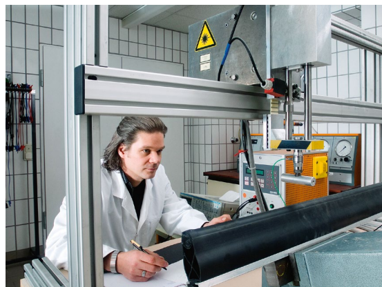
Prüfung des Ansprechverhaltens einer Schaltleiste
