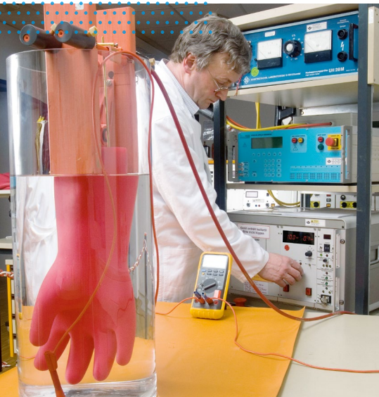
Isolationsprüfung an einem isolierenden Handschuh mit Messung des Ableitstromes
