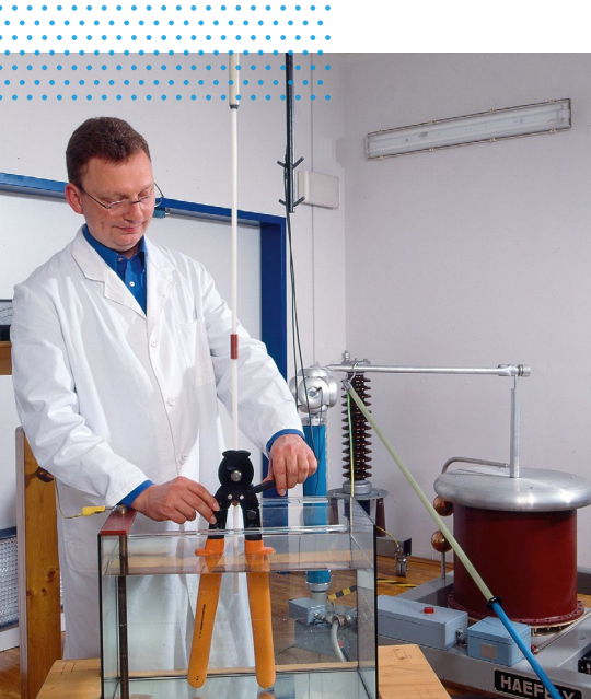
Isolationsprüfung an einem Werkzeug zum Arbeiten unter Spannung
