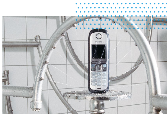
IP-Schutzartprüfung an einem Mobilteil einer Personen-Notsignal-Anlage
